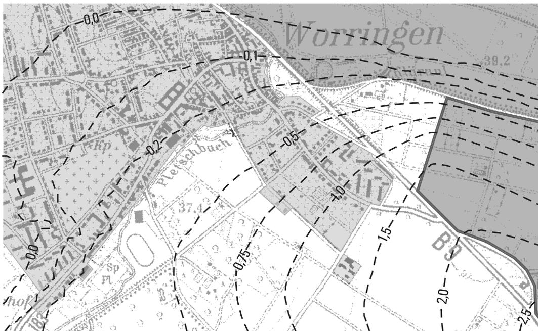
**Abb. 2.6:** Differenz aus Grundwasserstand nach Flutung des Rückhalteraums und maximal tolerierbarem Grundwasserstand
